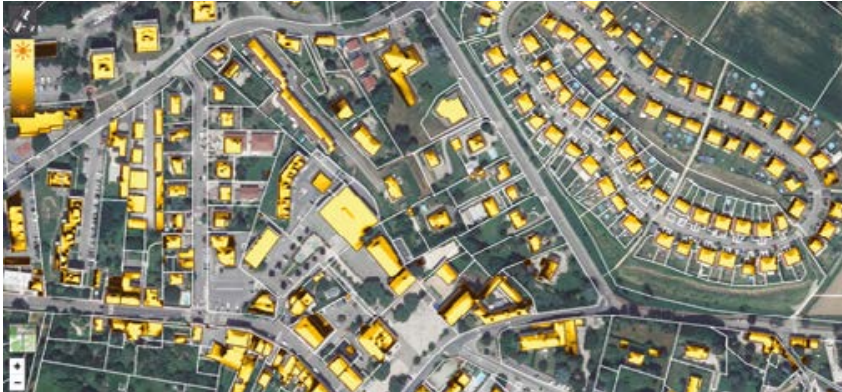
Vue aérienne de Pont-Évêque avec l'ensemble des toitures de bâtiments en jaune pour connaître le niveau d'ensoleillement
